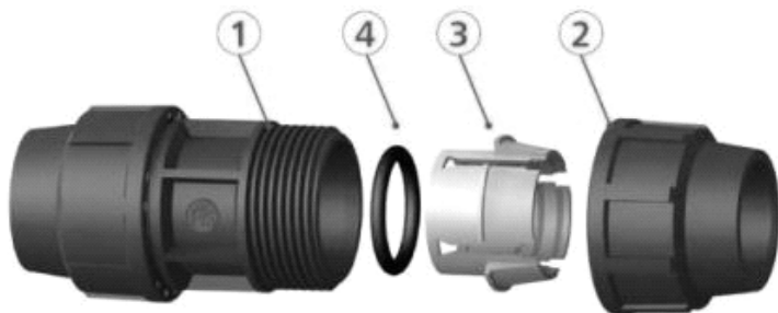
Рис. 20. Механічне з'єднання за допомогою компресійних фітингів
