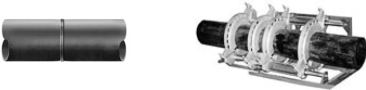
Рис. 18. Стикове зварювання поліетиленових труб
